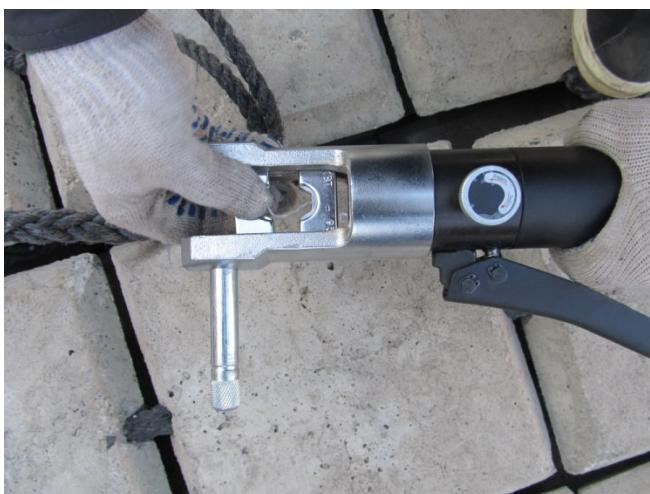
Подготавливается ручной гидравлический пресс. Для каната диаметром 10 мм используется матрица для пресса сечением  $95 \text{ mm}^2$ .
