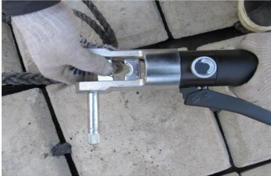
Подготавливается пресс. Для каната диаметром 10 мм используется матрица для пресса сечением 95 мм<sup>2</sup>, для каната диаметром 11 мм – 125 мм<sup>2</sup>.
